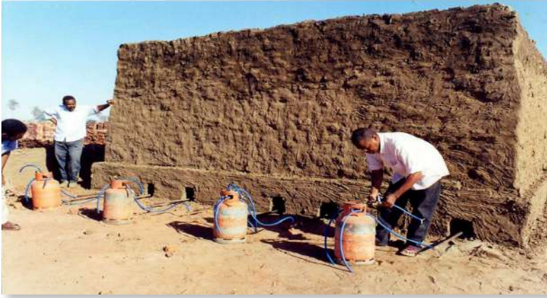
شكل (٣-٢) : صناعة الطوب الأحمر باستخدام الغاز
